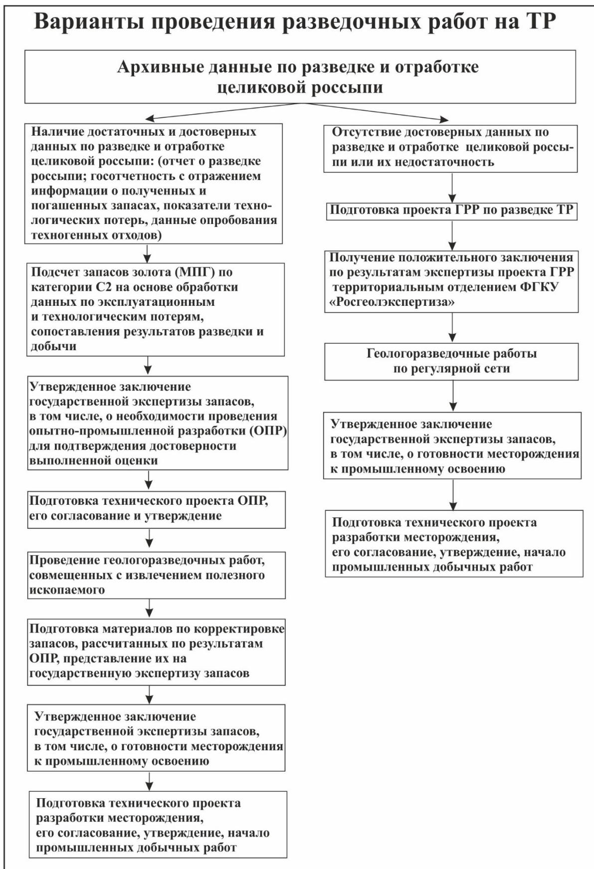
Рис. 2.1 Последовательность проведения геологоразведочных работ на ТР в зависимости от наличия ретроспективных данных
