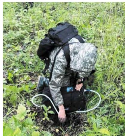
Рисунок 4. Замер содержания паров ртути в подпочвенном воздухе
