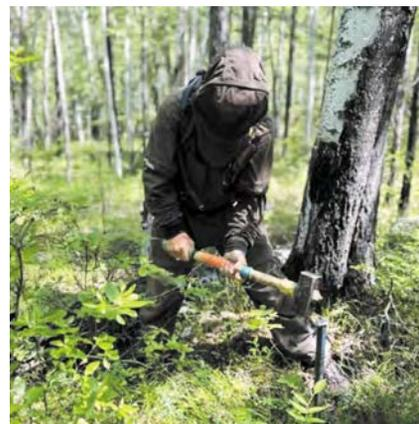
Рисунок 3. Процесс проходки шпура
