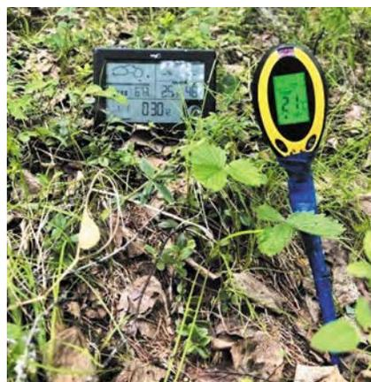
Рисунок 5. Фиксация температуры почвы и атмосферных параметров
