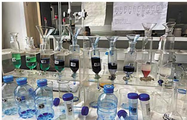
Рисунок 4. Внешний вид экстракционного каскада делительных воронок
