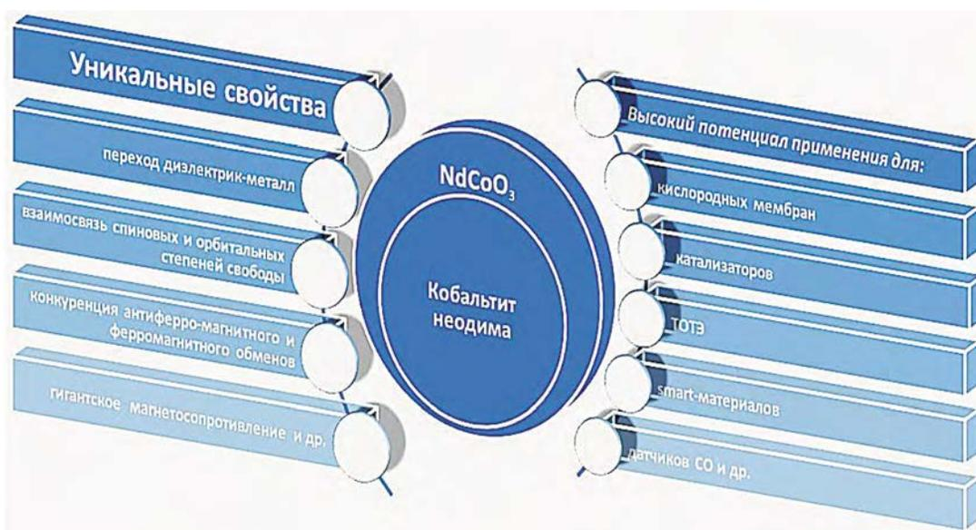
Рисунок 1. Некоторые свойства и направления применения кобальтита неодима
