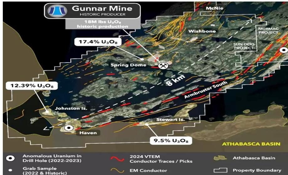
Рис. 1. Проект Sun Dog, целевые зон бурения, м-ния урана и электромагнитные проводники.
