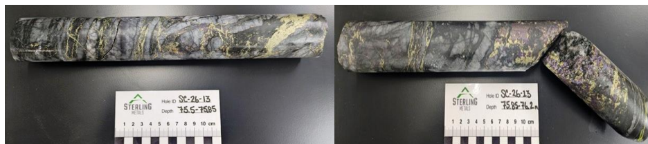
Рис. 2 КERN ленточной жилы с высоким содержанием халькопирита и борнита на глубине 75 м.
