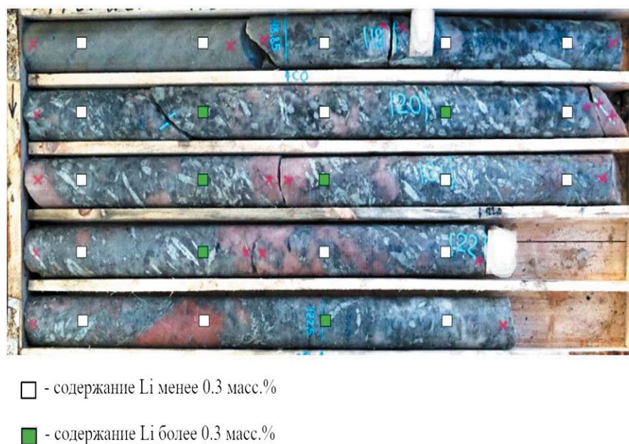
Рис. 8. Пример сподумен-полевошпатового пегматита с крупнозернистой текстурой и нанесенной схемой точек измерений прибором LIBS
