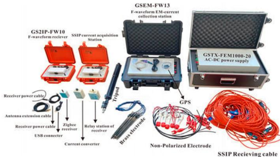
Рису. 3. Набор оборудования, используемого при геологоразведочных работах SSIP (модифицировано из GSAI)
